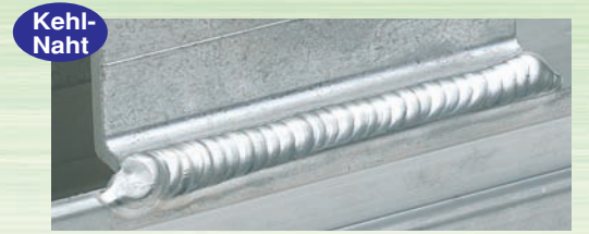
Schweißstrom 130A, AC Frequenz 150 Hz, Geschw. 25 cm/min. Blechdicke 3 mm
