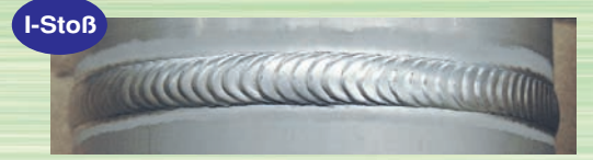
Pulsstrom 200A, Grundstrom 20A, Pulsfrequenz 2 Hz, AC Frequenz 150Hz, Geschw. 20 cm/min., Blechdicke 4 mm
